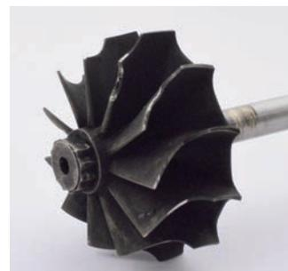
Поломка колеса турбины из-за многоциклового усталости
