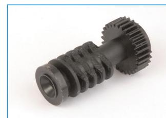
Fehlfunktion des Schneckengetriebes aufgrund eingeschränkter Funktion des VNTC-Mechanismus
