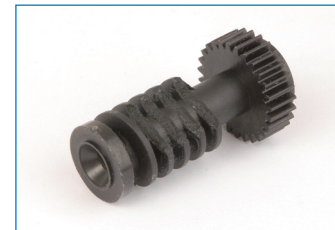
Fehlfunktion des Schneckengetriebes aufgrund eingeschränkter Funktion des VNTC-Mechanismus
